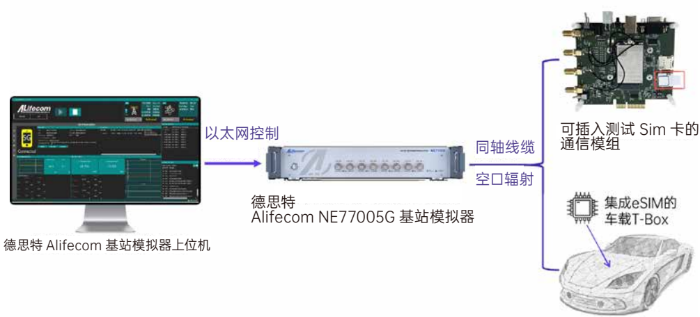
TBOX 入网测试的测试架构: 支持 Sim 和 eSim
