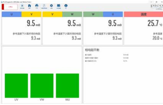
三相电机毫欧测试结果
